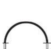
Halbrundbogen Plein cintre Semi-circular arch
